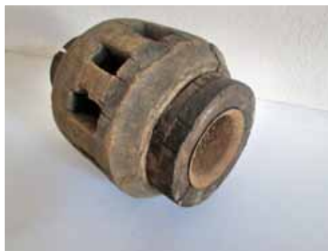
Ступица – деревянная ось в деревянном колесе телеги
